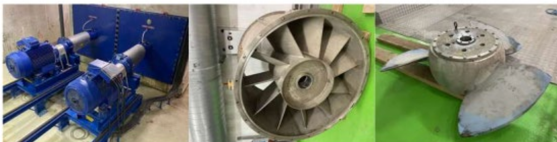
Figure 2 : 2 pompes de 250Kw chacune du bassin à gauche, le redresseur au milieu et l'hélice à droite
